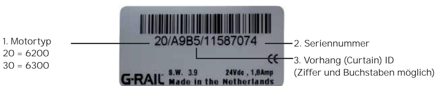
Bei einem Tandemsystem steht auf den Aufkleber von beiden Motoren der Text "**Partner ID**" mit beigefügtem Code des Partnermotor.
